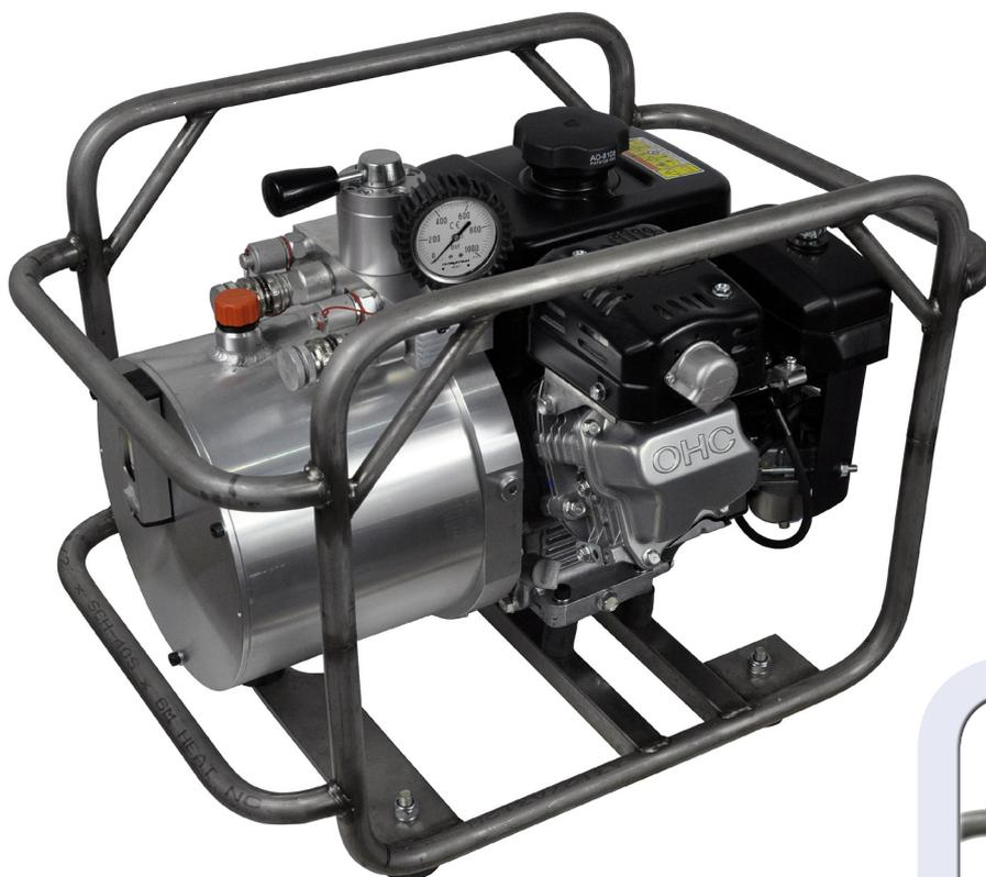
Bomba hidráulica de 700 bares de doble efecto :
