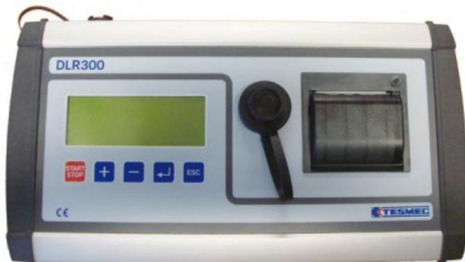
Una impresora integrada permite la impresión de los diferentes parámetros.
